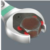
clevere Doppelsechskant-Geometrie des Jokers macht die Verbindung mit Schraube oder Mutter formschlüssig - das sitzt. Und die auswechselbare. gehärtete Metallplatte im Maul des Jokers verbeißt sich mit extrem harten Spitzen in die Schraube. Beides verringert die Abrutschgefahr auch bei hohen Drehmomenten.
